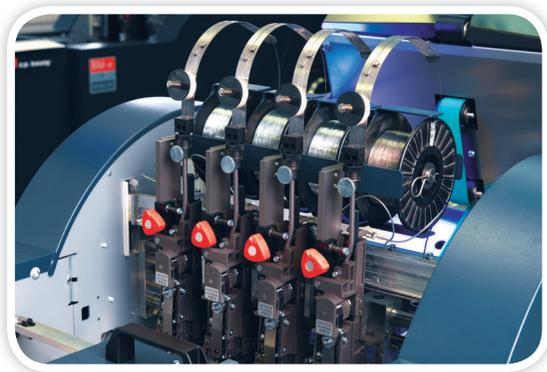
Les modules de fabrication de livrets brochés C.P. Bourg sont des systèmes de finition en ligne et near line/hors ligne complètement automatisés qui brochent, plient et massicotent de grands formats de feuilles pour créer plus de 14 types de positions de piqûres sur des livrets pour répondre aux besoins de votre entreprise.
