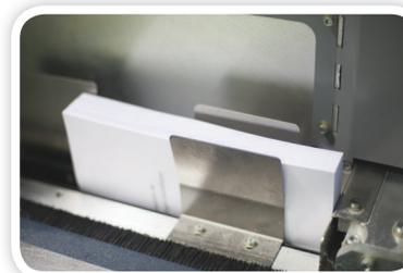
Chaque fois que l'opérateur charge un livre d'une épaisseur différente dans le BB3002 EVA, les spécifications sont automatiquement mesurées et aucune entrée manuelle n'est requise.
