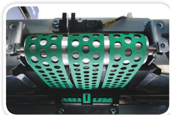
Grâce à l'approche innovatrice de C.P. Bourg, le margeur de feuilles Bourg (BSF) peut accepter des feuilles assemblées quelque soit le nombre ou la marque d'empileuses d'impression, y compris des processus analogiques. Le BSF aligne automatiquement la pile entrante en fonction de sa ligne médiane et les charge dans vos modules de finition respectifs.
