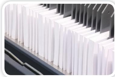
En moins de six minutes, l'opérateur peut charger jusqu'à 120 corps d'ouvrages dans le BBL, et ensuite réaliser d'autres tâches - telles que l'emballage de livres qui viennent d'être produits - alors que le BB3102 fonctionne sans surveillance pendant 25 minutes maximum.
