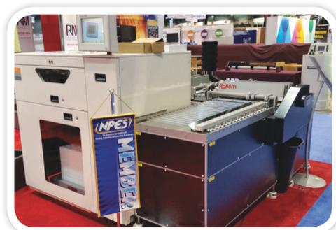
Margeur de feuilles Bourg BSF travaillant en ligne avec un chariot Rollem JetSlit
